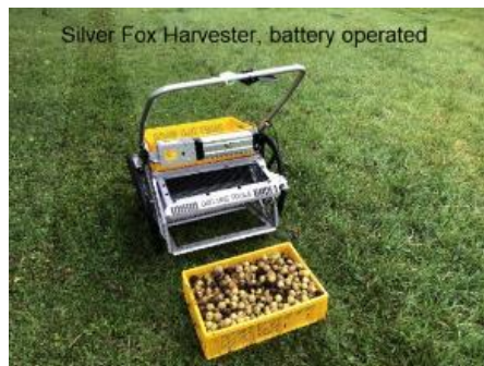
Figure 3. Outil électrique à batterie de récolte des noisettes au sol « Silver Fox Harvester »
