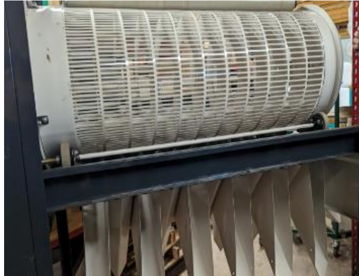
Figure 26. Calibreur « Badger Drum Sizer »
