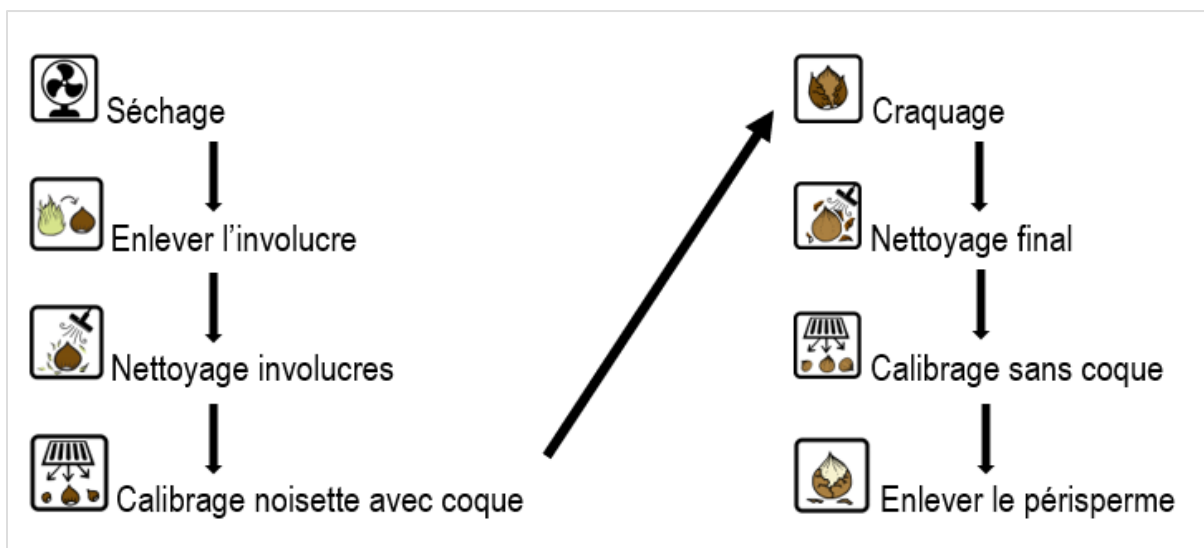
Figure 24. Étapes de conditionnement de la noisette (Source : Biopterre 2022)
