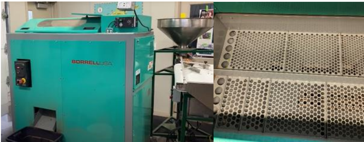
Figure 27. Appareil de retrait des coques et calibreur « Borrell Sample Sheller »
