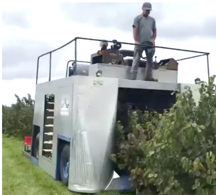
Figure 23. Récolteuse automotrice utilisée pour la récolte des noisettes
