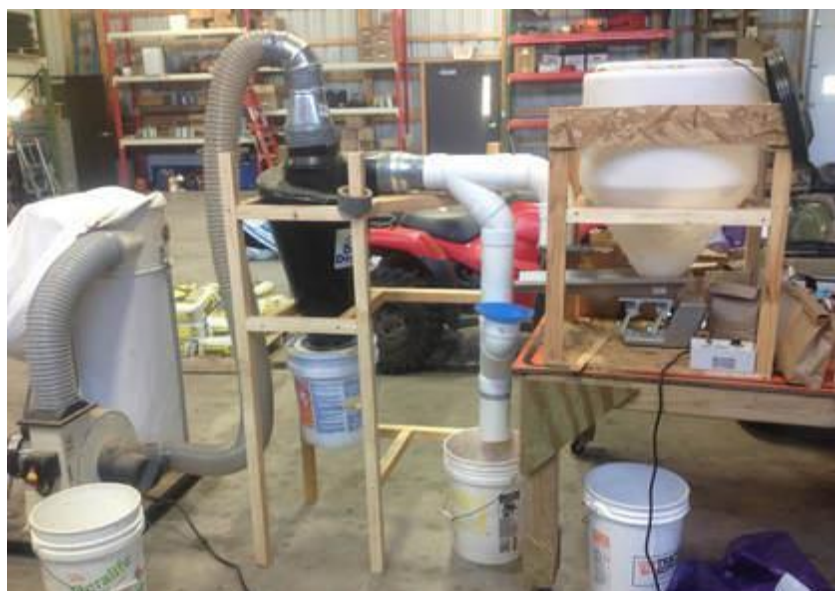
Figure 25. Aspirateur, nettoyeur d'involucre artisanal « Badger Aspirator »
