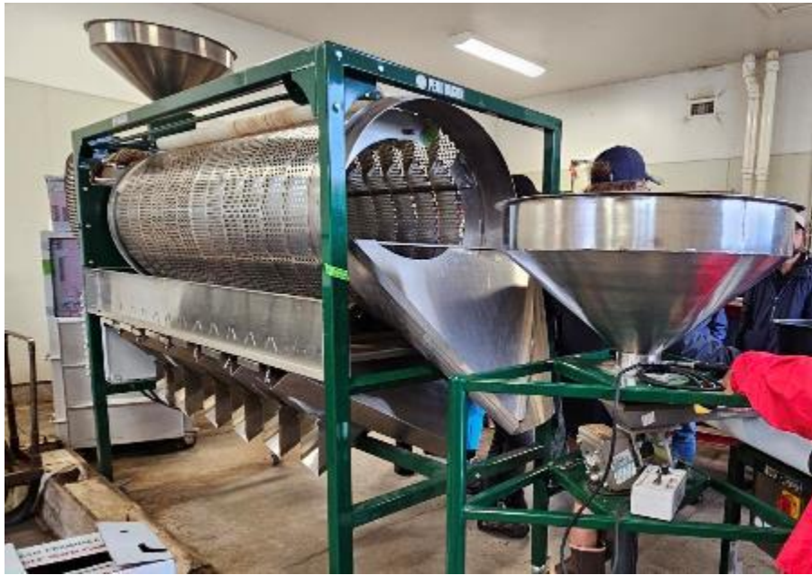
Figure 28. Séparateur de coques et calibreur de noisettes sans coque « DSR1260 Drum-Sizer »
