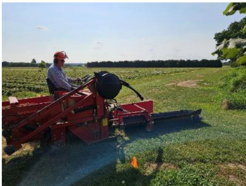
Figure 7. Récolteuse mécanisée autoportée « OB 70 R de Feucht Obsttechnik »
